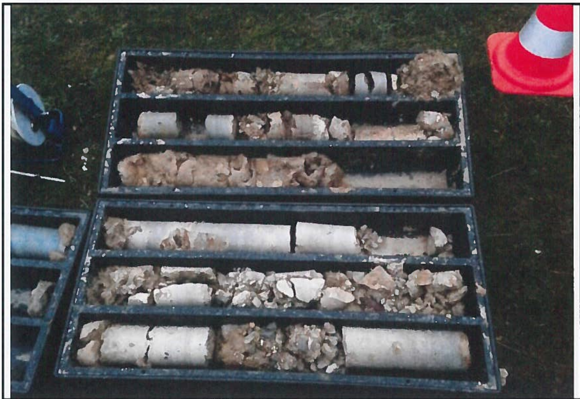
Photographie : 13 Carottes de roche – MW4 (zone fracturée profonde)
