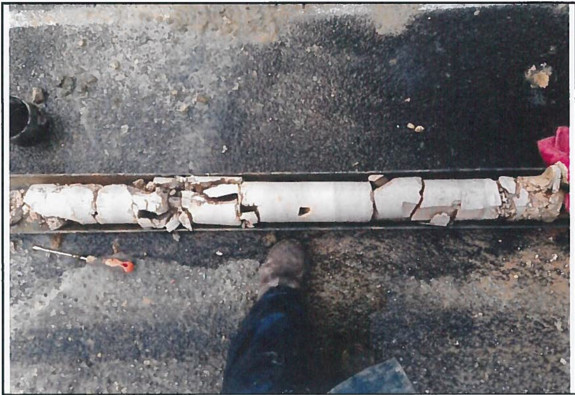
Photographie : 15 Carotte de roche – MW6 (dernier mètre du forage)
