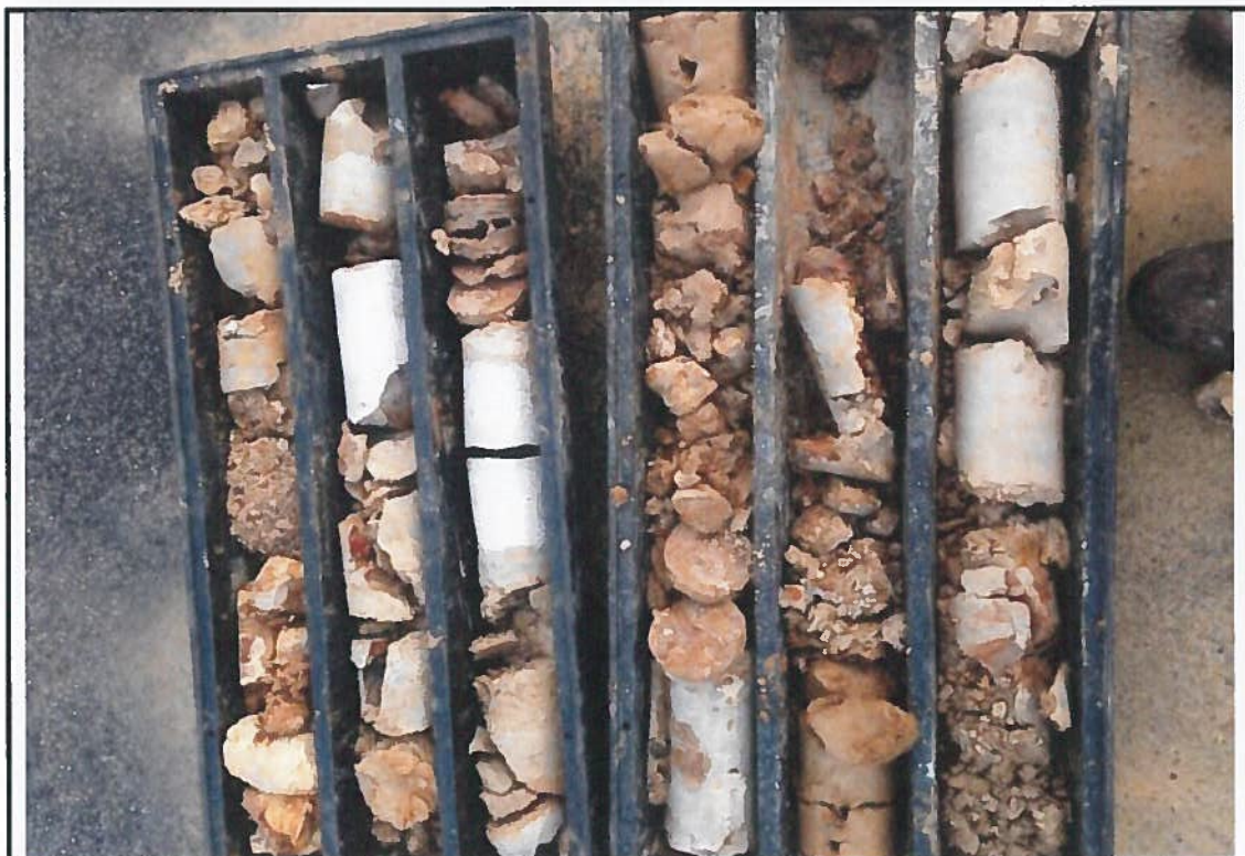
Photographie : 16 Carottes de roche – MW 8 (roche hautement fracturée sur l'ensemble du forage)
