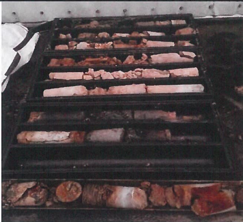
Photographie : 9 Carottes de roche fracturée (MW2)
