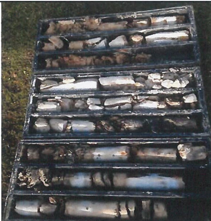
Photographie : 10 Carottes de roche - MW3 (calcaire compact en bas de la photo)
