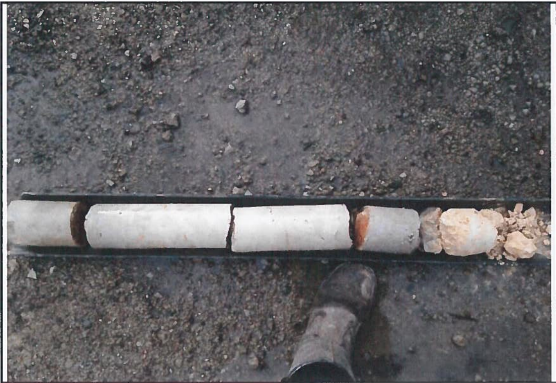
Photographie : 17 Carottes de roche – MW9 (dernier mètre du forage – calcaire compact)
