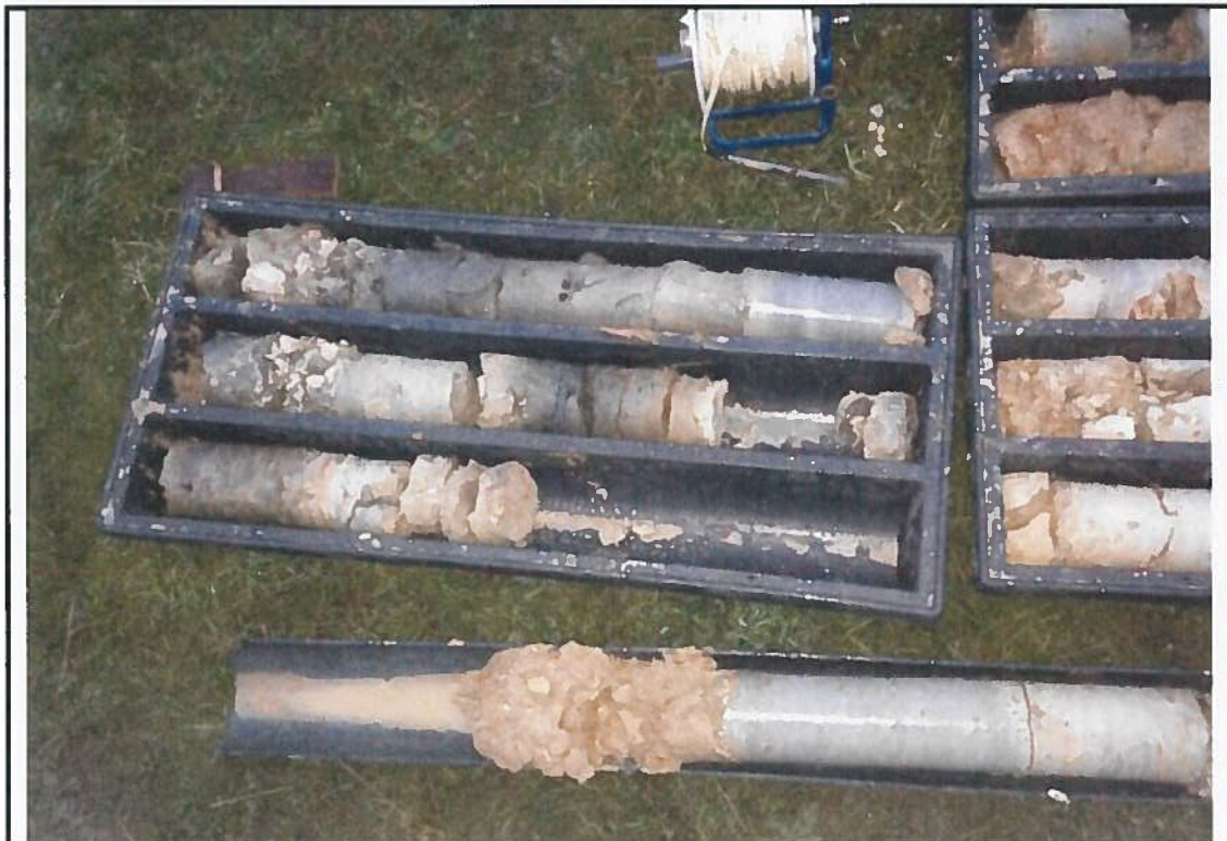
Photographie : 12 Carottes de roche - MW 4 (calcaire compact visible au bas de la photo)
