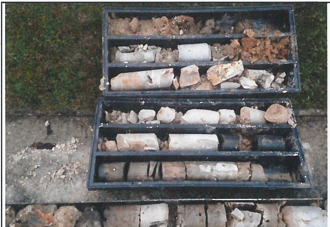
Photographie : 14 Carottes de roche – MW5 (roches hautement fracturées sur l'ensemble du forage)
